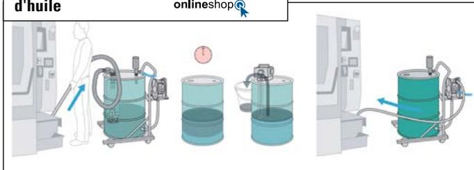
Utilisation combinée : PumpOut (voir ci-dessus) aspire l'eau de refroidissement hors de la machine et sépare les particules du liquide. Un séparateur d'huile sur l'ouverture 2" du récipient écope l'huile de la surface. Ensuite, le liquide purifié est refoulé dans la machine.
