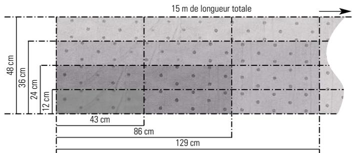
Grâce au multiple prédécoupage dans le sens de la longueur et de la largeur, il est facile de découper le format adapté à chaque situation.
